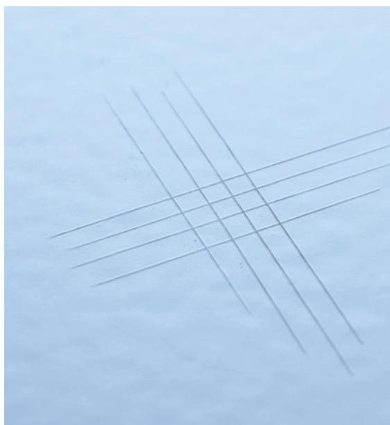
Der Gitterschnitt belegt die sichere Direkthftung.
