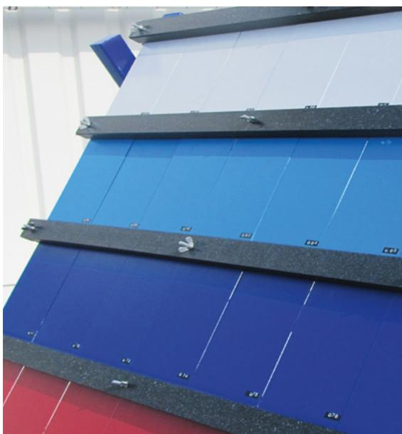
Super-Dickschutz Uni lässt sich in beliebig vielen Farben tönen. Seine Stärke: Optimale Haftung und sicherer Korrosionsschutz. Auf dem Wetterstand wird die Haftung auf vielen Untergründen in mehreren Farbtönen auf die Probe gestellt.
