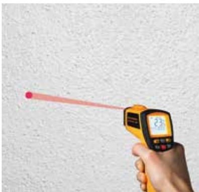
◀ **Temperaturmessung** (Lufttemperatur, Temperatur des Putzgrundes).
