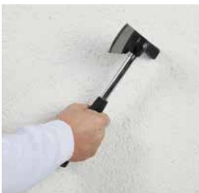
◀ **Klopfprüfung** mit geeignetem Werkzeug zur Überprüfung auf Hohlstellen.
