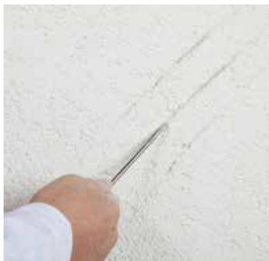
◀ **Kratzprobe** mittels eines harten Gegenstandes, um festzustellen, ob Teile des Untergrundes abplatzen, abblättern oder absanden.
