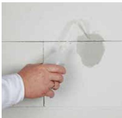
◀ **Benetzungsprobe** durch Annässen an mehreren Stellen, um festzustellen, ob Reste von Schalungstrennmitteln vorhanden sind, oder der Untergrund nur unzureichend saugt, z. B. bei noch feuchtem Beton oder dichter Sinterhaut.
