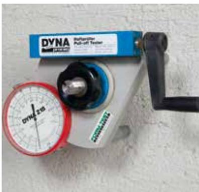
◀ **Haftzugprüfung** mittels Prüfgerät.
